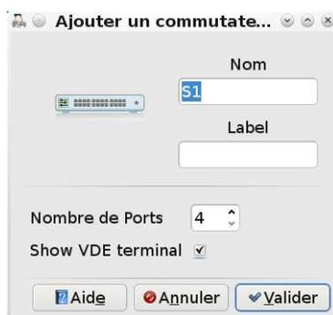
Si l'on coche cette case puis on démarre le commutateur, on observera apparaître un terminal de configuration du commutateur en plus de la fenêtre de leds habituelle :
